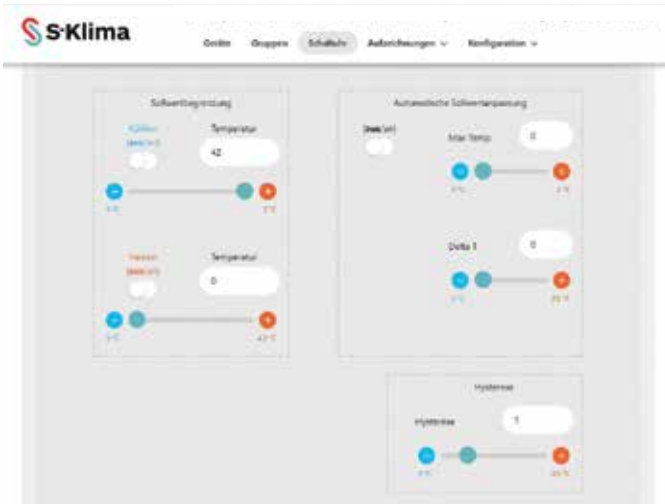
In het expertaanzicht zijn de temperatuurgrenswaarden en de hysteresie bij koelen en verwarmen in te stellen, hierdoor wordt het systeem nóg beter in te regelen.
