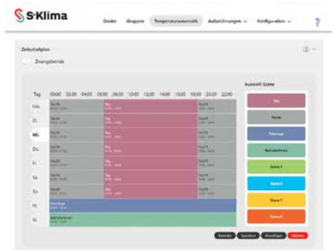
De tijdklokken kunnen intuïtief middels „drag & drop“ worden geconfigureerd. Door de vele verschillende kleuren zijn de scènes in een oogopslag uit elkaar te houden.
